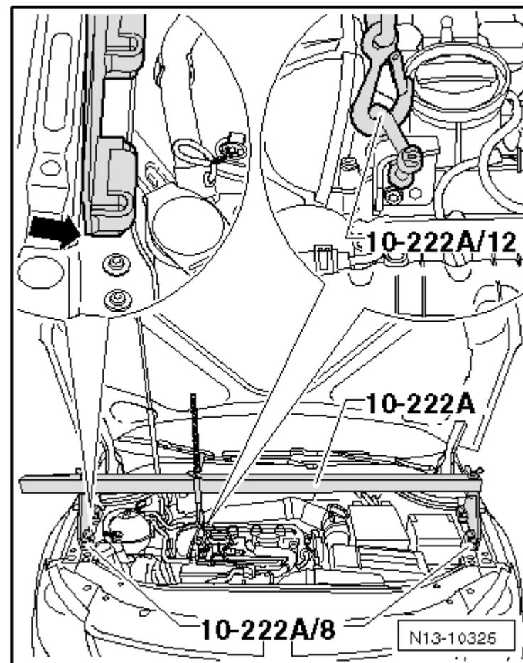
– Выкрутить болты крепления -стрелки- опоры двигателя.
